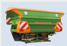
Épandeur intégrant le système de pesée ZA-M Profis 1500-3000 l, 10-36 m
